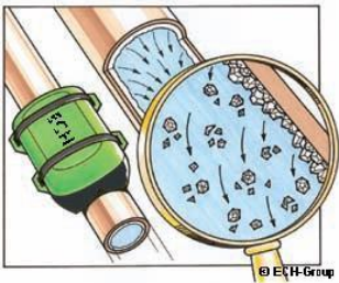
Na montage van de Alpine waterontharder new generation® laat oude kalklaag los en vergruist.
